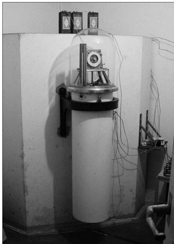
Fig. 3: Pendule de haute précision sous cloche isobare. Cette photo est historique, le pendule ayant été démonté au début de cette année, provoquant une perte importante du patrimoine de l'Observatoire.
